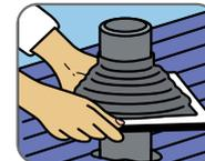
2) Deslizar o Master Flash® pressionando sobre o tubo. Se necessário usar lubrificante que não seja à base de petróleo para facilitar a instalação.
