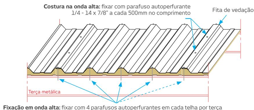
**Fixação em onda alta:** fixar com 4 parafusos autoperfurantes em cada telha por terça
