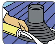
4) Aplicar selante de poliuretano entre a base do Master Flash® e o telhado.
