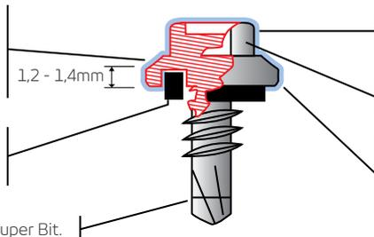
Capa de aço inox série 302 e marcação H na cabeça do fixador.
