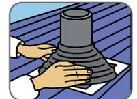
3) Conformer a base do Master Flash® para que se adapte ao perfil e irregularidades do telhado. Se necessário usar uma ferramenta leve para formar os ângulos.
