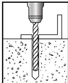
1) Usar a broca apropriada, fazer o furo no material-base com a profundidade de 20 mm a mais que o embutimento requerido. Inserir o chumbador HARDBOLT através do suporte furado e proceder a instalação.
