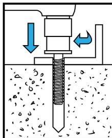
2) Começar a instalação do chumbador aplicando uma pressão sobre a cabeça para laminar os primeiros fios de rosca. Continuar apertando até assentar a cabeça firmemente contra o suporte. Em materiais mais densos, recomenda-se o uso de chave de impacto.
