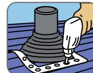
5) Para finalizar a instalação aplicar parafusos de costura ponta 1, com distância de até 38mm.
