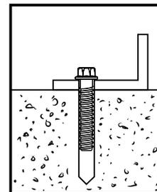
3) Verificar se o embutimento está correto e o torque máximo não foi ultrapassado. A instalação estará agora completa.
