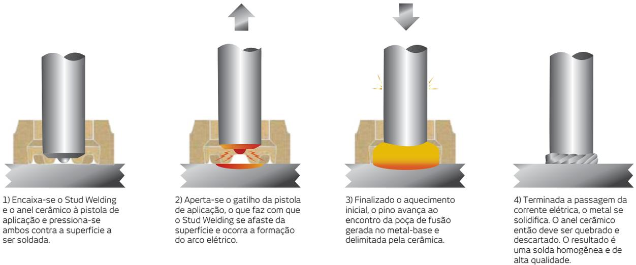
1) Encaixa-se o Stud Welding e o anel cerâmico à pistola de aplicação e pressiona-se ambos contra a superfície a ser soldada.
