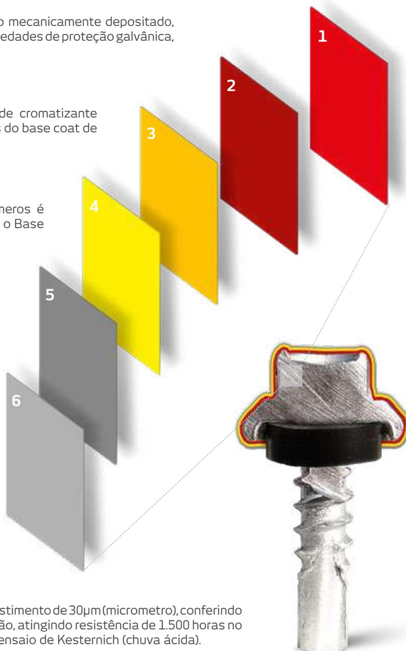
A combinação de todas estas etapas forma um revestimento de 30µm (micrometro), conferindo desempenho superior aos diversos tipos de corrosão, atingindo resistência de 1.500 horas no ensaio de Salt-spray (névoa salina) e 30 ciclos no ensaio de Kesternich (chuva ácida).
